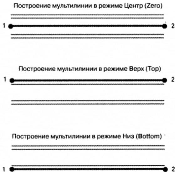
*Верх и Низ* - мультилиния строится путем указания начальных и конечных точек крайней верхней или крайней нижней линии мультилинии.
